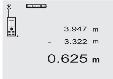
經由彼此相減，可以很方便地計算個別距離，例如用在測定管線底部到天花板間的距離時。將地板到天花板的距離和地板到管線底部的距離相減即可。如果減去管線直徑，則為管線頂端到天花板的距離。
